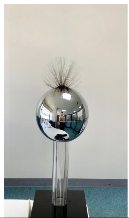
人毛毛束に静電気を帯電させる
